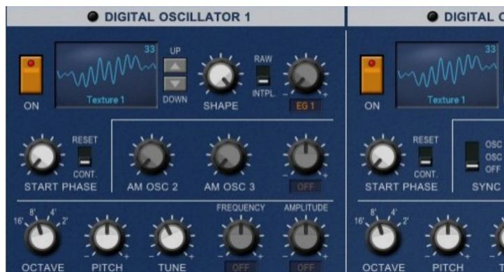
L'oscillateur 1 dispose d'une modulation d'amplitude supplémentaire par l'oscillateur 2 et/ou l'oscillateur 3, alors que les deux autres oscillateurs peuvent être synchronisés (Hard Sync) et une modulation de fréquence linéaire..
