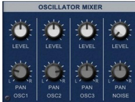
Les signaux des trois oscillateurs ainsi que le signal de bruit blanc supplémentaire sont envoyés au mixeur. Chaque signal a sa propre commande LEVEL et PANORAMA (stéréo). La sortie du mixeur est ensuite dirigée dans la section de filtre.
