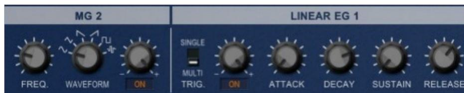
En plus des générateurs d'enveloppe de filtre et d'amplitude, WhispAir dispose de deux générateurs d'enveloppe (EG) à usage général à pente linéaire, trois générateurs de modulation nommés MG 1, MG 2 et Vibrato. Ces trois générateurs de modulation peuvent être synchronisés au tempo de l'application hôte. MG1 et MG2 ont des formes d'onde différentes alors que le Vibrato ne produit qu'une onde sinusoïdale.
