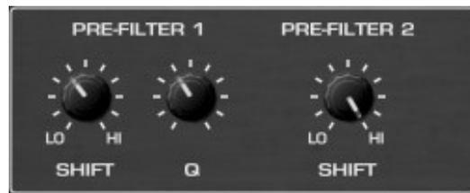
Le premier (Pre-Filter 1) est utilisé pour les presets Chorus et se compose de six filtres passe-bande à 2-pôles - leurs entrées individuelles sont dérivées de différentes plages de clavier, alors que le facteur Q (correspondant à la bande passante ou Qualité) de ces filtres peut être réglé de 0,2 à 10, les fréquences centrales peuvent être décalées d'un facteur allant de 0,25 à 4.
