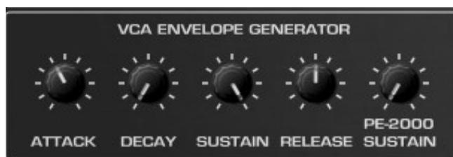
Ici, la commande "SUSTAIN" du mode standard est étiquetée "PE-2000 SUSTAIN" et se comporte de la façon suivante : Tant que sa valeur est supérieure à "RELEASE", elle règle le temps de "Sustain" paraphonique. Une fois qu'il est inférieur à "RELEASE", il n'a aucun effet.
