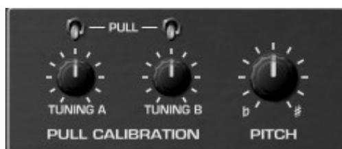
Le bouton "PITCH" contrôle l'accord général tandis que "TUNING A" et "TUNING B" peuvent être utilisés pour (dés)accorder les banques d'oscillateurs A et B par rapport à la troisième banque d'oscillateurs C. La plage est limitée à  $\pm 50$  cents.
