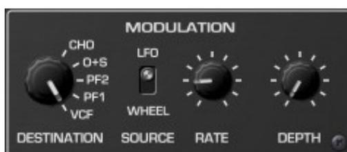
Ceci est une autre caractéristique exclusive de PECS : vous pouvez choisir un signal de modulateur à partir d'un LFO à onde triangulaire ou du contrôle MIDI de la molette de modulation pour moduler l'une des cinq destinations : le VCF, le pré-filtre 1, le pré-filtre 2, l'O+S Filter ou Chorus Filter cutoff/fréquences. Pas si fabuleux que ça, je sais, mais assez pour ajouter une (vraie) ambiance supplémentaire...
