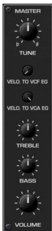
La section Master contient les commandes pour le réglage principal, l'égaliseur et le volume principal. De plus, il ajoute deux boutons pour régler le taux de vélocité modulant l'intensité des EG VCF et VCA (le PE-2000 n'était pas sensible à la vélocité mais pour éviter une autre tempête de critiques, j'ai préféré l'ajouter au PECS).
