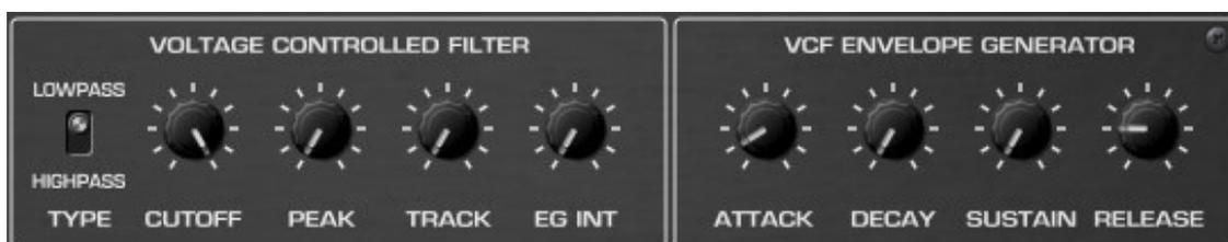
Le VCF est un filtre bipolaire inspiré du circuit KORG K35 classique tel qu'il a été intégré à la série PS-3X00 (c'est-à-dire sans l'option d'auto-oscillation) et est livré avec son propre générateur d'enveloppe ADSR (EG). Notez qu'il y a un VCF par voix, donc toute la configuration est en fait polyphonique. Les commandes sont assez standard : Type (passe-bas ou passe-haut), fréquence de coupure, crête (résonance), suivi du clavier et intensité de l'EG.
