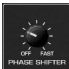
PECS dispose d'un effet de Phaser à 6-stages avec un taux de modulation contrôlable. Bien sûr, l'effet peut être désactivé.
