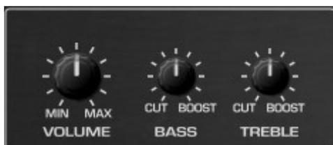
Il n'y a pas grand-chose à dire à ce sujet; il s'agit d'un filtre passe-bas et d'un filtre passe-haut en plateau qui peuvent facilement conduire à un écrêtage.
