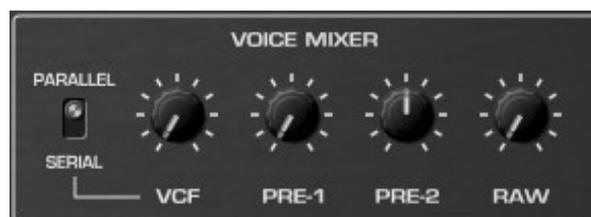
En utilisant le commutateur d'arrangement de filtre, on peut décider si les signaux de pré-filtre sont dérivés directement des banques d'oscillateurs ("PARALLEL") ou du signal VCF ("SERIAL"; voir le schéma dans la section "Vue d'ensemble").
