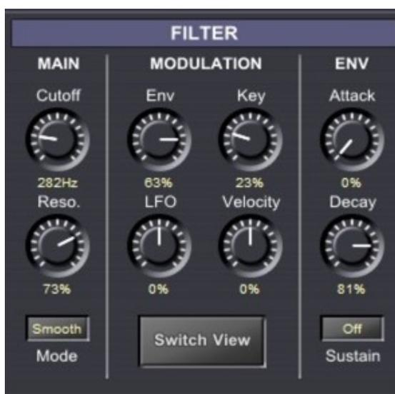
Le filtre est basé sur un design (attention, c'est un mot à la mode) Zero-Delay Feedback et offre deux modes : le premier, Smooth est un filtre passe-bas 4-pôles avec non-linéarités modérées et auto-oscillation potentielle, le second, Dirty est un filtre passe-bas 2-pôles mais celui-ci n'est pas capable d'entrer en auto-oscillation. La fréquence de coupure et la résonance sont évidemment modifiables.
