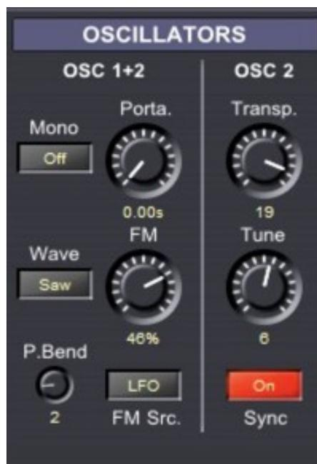
Le Kern possède deux oscillateurs à bande limitée qui peuvent générer des formes d'onde en dent-de-scie ou Carrée, la forme d'onde est sélectionnée pour les deux oscillateurs simultanément. L'oscillateur 2 peut être transposé de +/- 24 notes et désaccordé de +/-1 note. De plus il est possible de synchroniser l'oscillateur 2 avec l'oscillateur 1.
