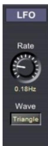
Le LFO propose trois formes d'onde : Triangle, Carrée et Sample & Hold (aléatoire). Sa fréquence est dans une plage de 0 à 100Hz.
