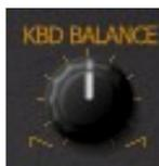
Après la section Resonators/Equalizer, le signal est traité par une caractéristique assez unique : Keyboard Balance qui ajuste le volume selon la hauteur des notes jouées sur le clavier. Avec le contrôle KBD Balance, vous pouvez atténuer les notes sur l'extrémité inférieure ou supérieure du clavier
