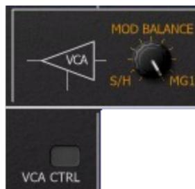
Le signal MOD est simplement un mélange équilibré entre le signal Sample & Hold et le signal MG1. Son amplitude peut être contrôlée par une source de modulation patchée sur le connecteur VCA CTRL. Cela facilite la création d'effets tels que le vibrato retardé.
