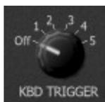
Ici, vous pouvez sélectionner combien de touches doivent être pressées (de 1 à 5) avant que cette source de déclenchement ne soit déclenchée (en position OFF par défaut, le clavier ne la déclenche pas).
