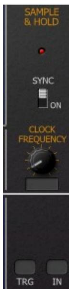
L'unité Sample & Hold (S/H) échantillonne tout signal envoyé dans la prise d'entrée IN. La fréquence d'échantillonnage peut être synchronisée avec le tempo de l'hôte. Alternativement, il va échantillonner l'entrée sur n'importe quelle impulsion de déclenchement à la prise TRG.
