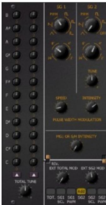
Les deux générateurs de signaux offrent 4 formes d'onde (Triangle, Dent-de-scie, impulsions et impulsion avec modulation), quatre plages d'octaves (de 16' à 2'). SG 2 dispose d'un accordage fin par rapport à SG 1, ou il peut même être désactivé complètement.
