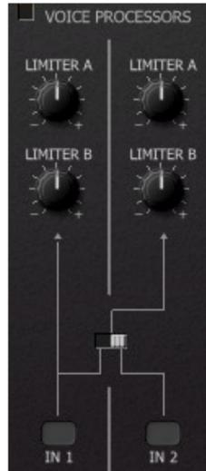
Dans le FB-3200, il y a deux processeurs de tension VP1 et VP2. Ils sont utilisés pour traiter le signal d'une source de modulation (par exemple MG ou GEG) pour produire un signal modifié. Voici comment cela fonctionne :
