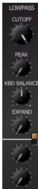
Le signal de sortie des générateurs de signaux alimente la section de filtre passe-bas 2-pôles avec résonance réglable (Peak). Il s'agit d'une modélisation de filtre Korg K-35, mais tout comme celui du PS-3100 il ne peut pas être poussé à l'auto-oscillation, désolé.
