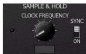
On a ensuite l'unité Sample & Hold (S/H). Par défaut, le S/H échantillonne la sortie de MG1 à une fréquence d'horloge fixe qui peut être synchronisée au tempo de l'application hôte. Ici encore, l'entrée peut être remplacée via le patchbay.
