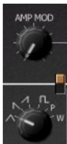
Après les résonateurs, le signal passe par un modulateur d'amplitude qui le multiplie par le signal de MG1 (peut être désactivé en utilisant le commutateur orange en bas de la section de modulation d'amplitude). Ici, le potentiomètre AMP MOD règle l'intensité et le caractère de l'effet comme suit :
