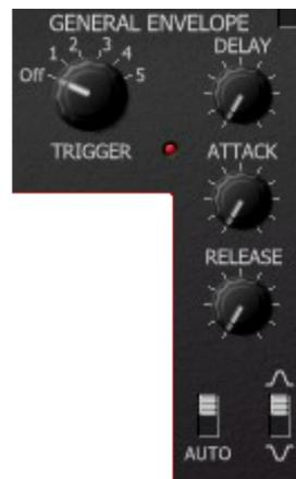
Le générateur d'enveloppe général est une enveloppe de type AR avec un paramètre Delay supplémentaire. Par défaut, il module le VCA1 (selon le réglage du switch orange). Il peut être transformé en enveloppe de type AD en activant le commutateur AUTO. Dans ce cas, le GEG une fois déclenché ignorera la phase de sustain et ira directement en phase de relâchement.
