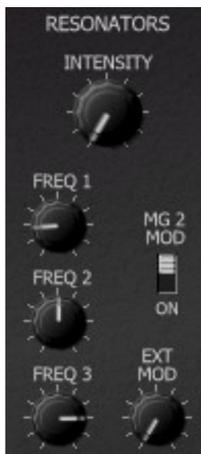
Comme indiqué précédemment, les signaux de voix individuelles sont mélangés en un seul signal mono et envoyés dans la section de résonateurs. Il s'agit essentiellement d'un agencement en parallèle de trois filtres passe-bande high-Q (c'est à dire des résonateurs) dont la fréquence centrale est réglable individuellement. Le contrôle INTENSITY détermine la balance entre le signal original et le signal d'effet.
